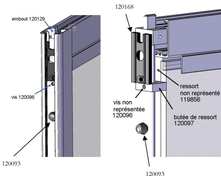
Oter la vis 120096 et la butée caoutchouc 120093
