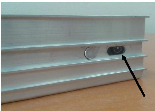
Serrer fortement la vis en insérant une clé Allen dans le trou oblong
