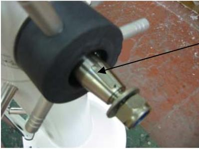
L'arbre utilise une clavette. Assurez-vous de ne pas la perdre car elle sera nécessaire pour monter votre roue Steer'n Go. Garder également la rondelle pour fixer le nouveau moyeu
