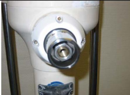
Placez le moyeu sur l'arbre et revissez l'écrou avec la clé à douille.
