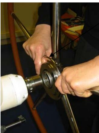
Présentez la roue sur le moyeu fixe en pressant vers vous la bague de verrouillage. Engagez-la à fond en maintenant toujours la pression sur la bague, puis relâchez la bague. Tournez doucement la roue. Le mécanisme est indexé. La roue s'enclenche automatiquement.
