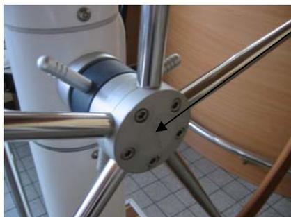
Dévissez les 5 vis du moyeu avec la clé Allen.
