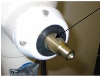
L'arbre utilise une clavette. Assurez-vous de ne pas la perdre, elle sera nécessaire pour le montage du moyeu de roue. Graisser le cône de l'arbre et le filetage avec une graisse marine afin de faciliter un éventuel démontage.
