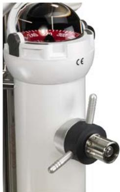
Présentez la roue sur le moyeu fixe en pressant vers vous la bague de verrouillage.
