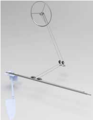
Système double safrans simple barre, avec appareil sur cloison Double rudders single bulkhead steerer system
