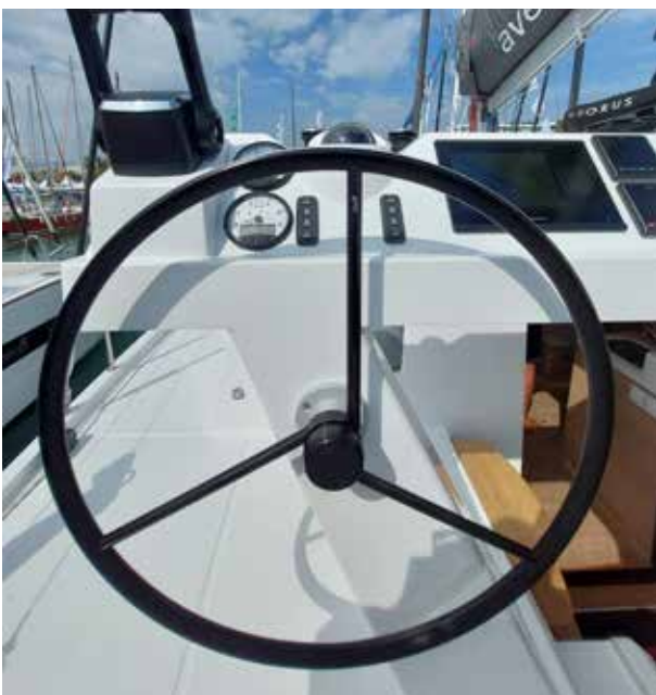
Système double safrans simple barre, avec appareil sur cloison Double rudders single bulkhead steerer system
