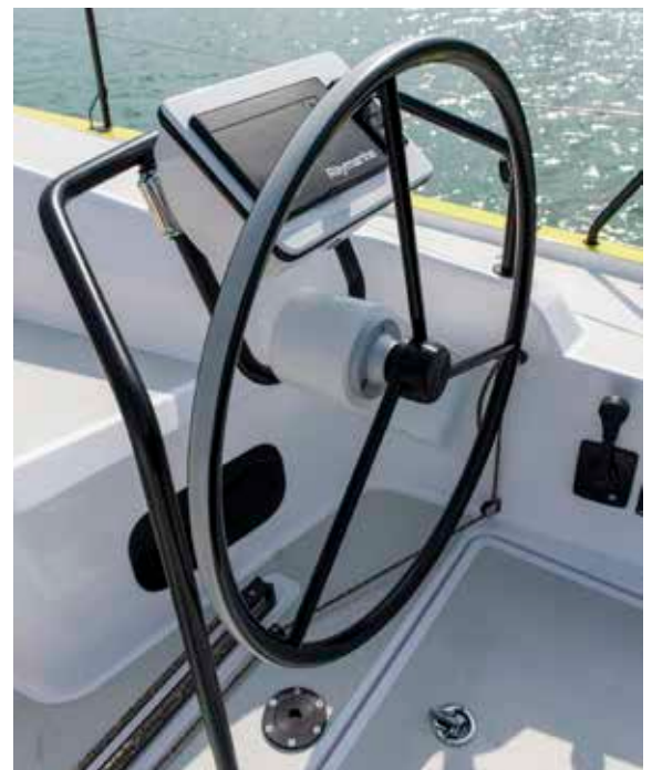
Système double barres double safrans, avec colonnes de barre Double bar system double rudder, with steering columns
