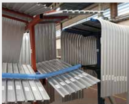
Habillages aluminium cintrés pour aménagement de camping cars. Bended aluminium covers for campers.
