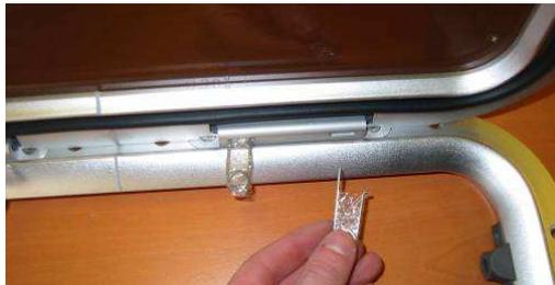
Les épingles ressort peuvent être conservées afin de procéder au démontage ultérieur de l'ouvrant.
