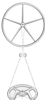
Cas le plus fréquent sur les voiliers modernes. L'alignement des drosses consiste simplement à monter ou descendre le secteur sur la mèche. Si le secteur est situé à l'avant de la roue, ne pas croiser les drosses.
