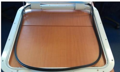
**Etape 7 :** Fermer l'ouvrant à 45° pour faire passer le joint en dessous et le positionner au dessus de la gorge du dormant
