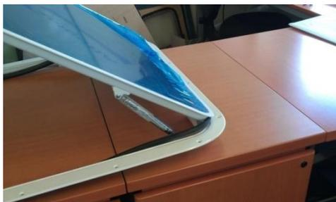
**Etape 8 :** Appuyer sur la base du joint (voir flèche jaune sur schéma) avec les doigts pour l'enclencher le pied dans la gorge, bien insister dans les coins.
