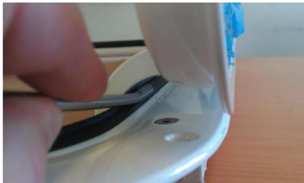
**Etape 10 :** Vérifier que le sommet de la lèvre du joint est parfaitement continu. Une « bosse » ou une « vague » signifie que le pied du joint est mal inséré à cet endroit. Voir exemple ci-dessous :
